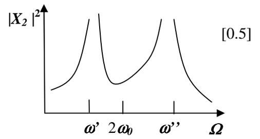
pour  $\Omega = \omega'$  et  $\Omega = \omega''$  :  $|X_1|^2$  et  $|X_2|^2$  tendent vers l'infini : **résonance** [1]
