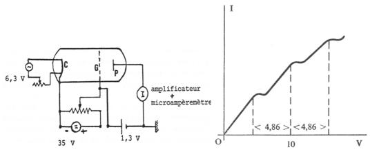
L'expérience consiste à mesurer le courant I du circuit de la plaque collectrice en fonction de la ddp V entre la cathode et la grille.
